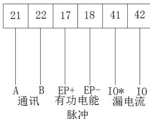
图 6 DDSY1352-4DM(5DM)辅助端子示意图
